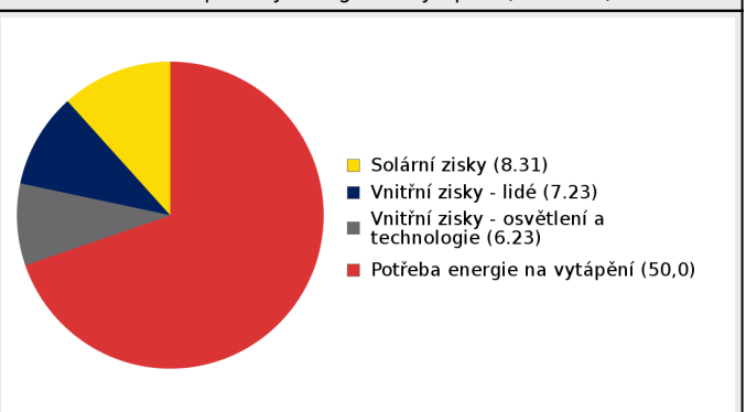
Bilance potřeby energie na vytápění (MWh/rok)
